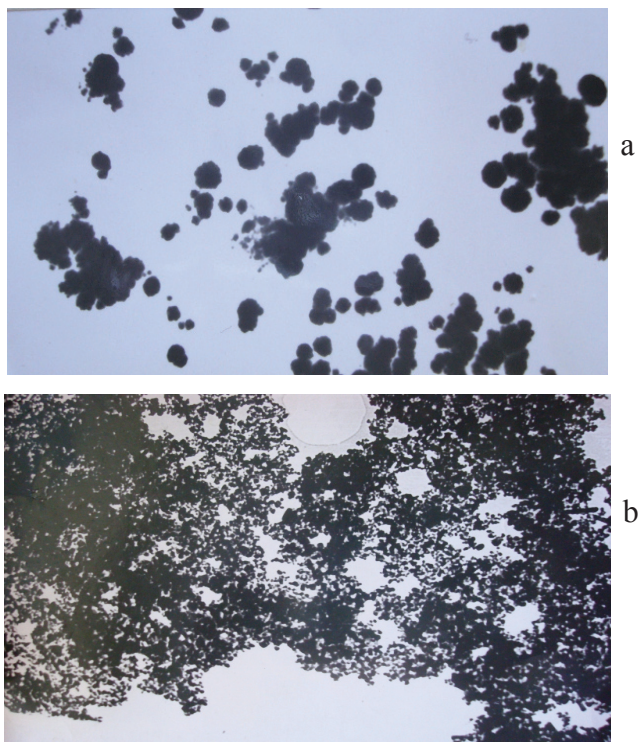
Рис. 2. Электронномикроскопические снимки исходного (а) и гидротермально обработанного гидрогеля SnO_2 при 400^\circ C , длительность обработки 25 часов (b). Увеличение 13000
